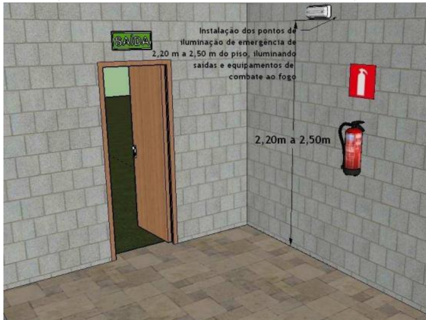
Figura 4 – Instalação dos pontos de iluminação de emergência
