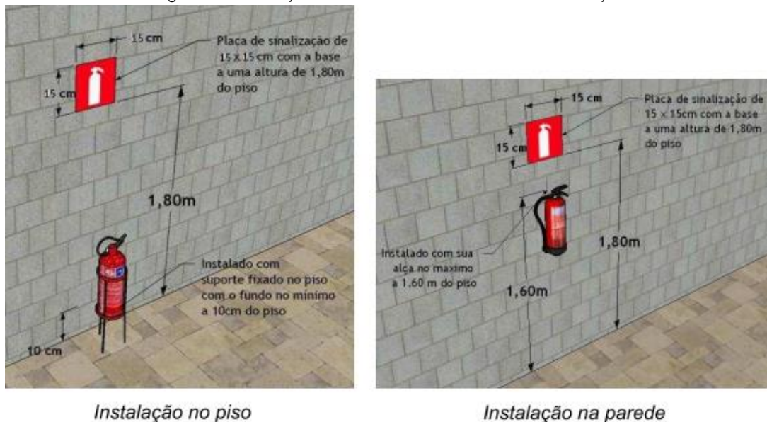
Figura 1 – Instalação de extintores de incêndio e sinalização
