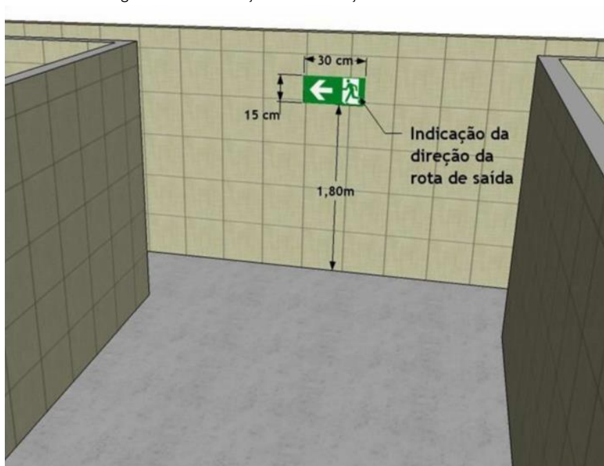
Figura 3 – Sinalização de indicação de rota de saída.
